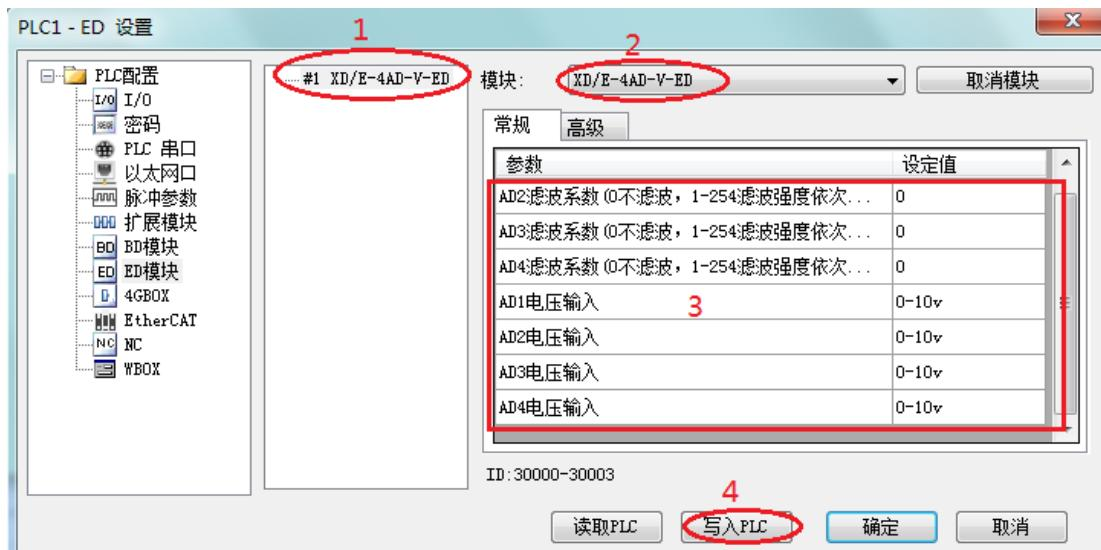
第一步：在图示“2”处选择对应的 ED 模块型号。
