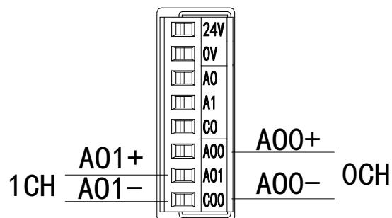
**注意：**电流输出无需串接 DC24V 电源！
