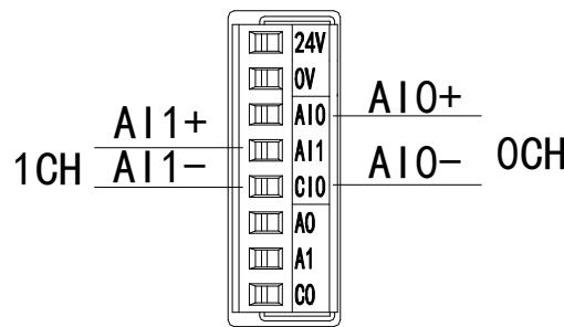
XD-2AD2PT-A-ED 电流输入侧接线如下图所示：
