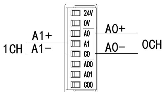
**注意：**对于三线制铂热电阻，请将颜色一样的两根引线接在 C0 端，另一根引线接在 A0 或 A1 端。
