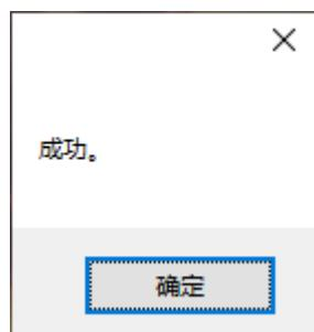
(6) 单击“确定”, 给 PLC 断电再上电, 串口配置才能生效。
