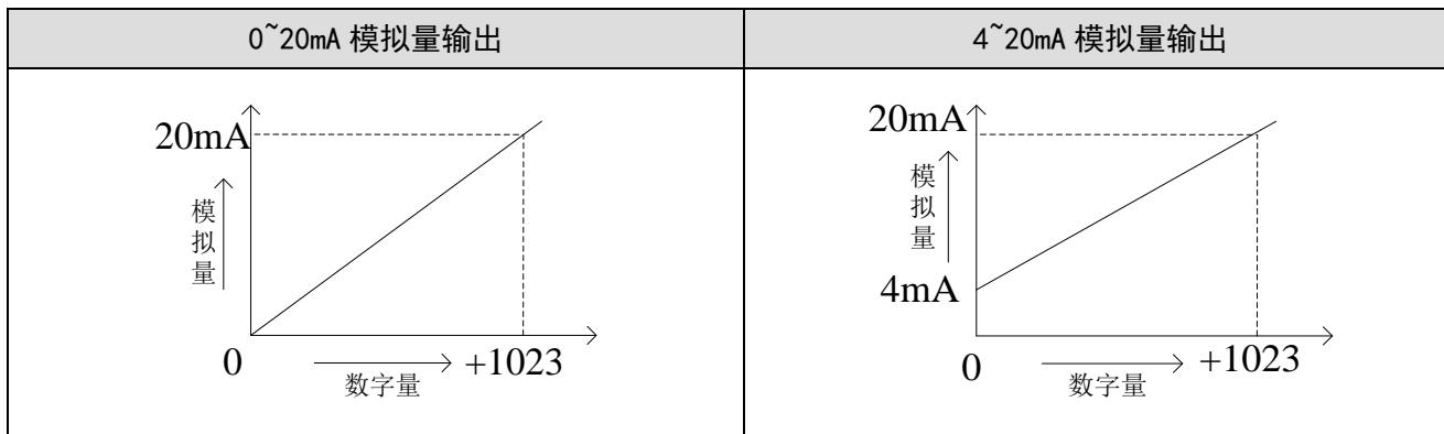
**注意：**当输入数据大于 1023 时，D/A 转换的输出模拟量数据保持 20mA 不变。
