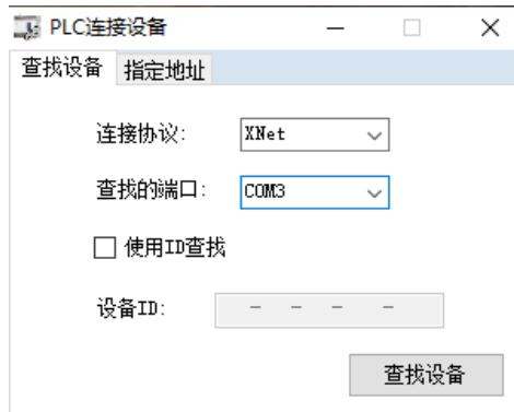
(3) 在“查找的端口”处选择你电脑与 PLC 的连接口，“连接协议”选择 XNet，点击查找设备，出现“PLC 配置”窗口。
