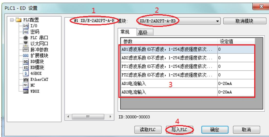
第一步：在图示“2”处选择对应的模块型号；
