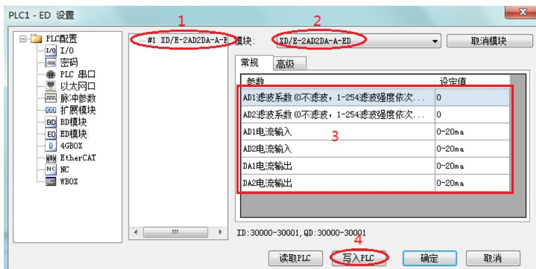
第一步：在图示“2”处选择对应的模块型号；
