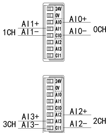
XD-4AD-A-ED 电流输入侧接线如下图所示：
