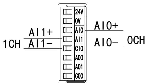
XD-2AD2DA-A-ED 电流输入侧接线如下图所示：
