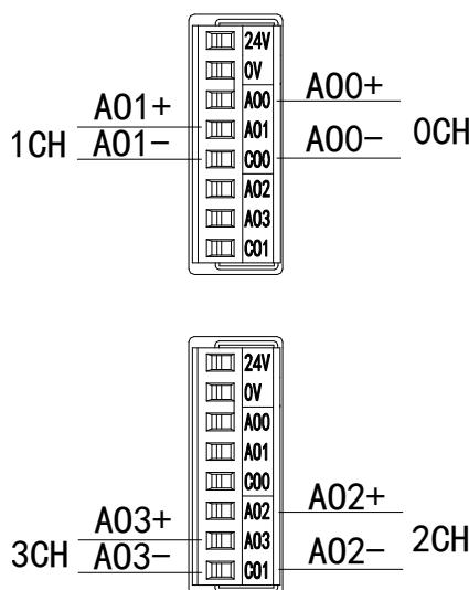
注意：电流输出无需串接 DC24V 电源！
