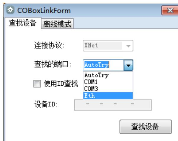
**【查找设备】:** 必须连接 CANopen 主站的 PLC, 且 PLC 串口 3 参数配置正确与 XD-COBOX-ED 通讯正常才能查找到 XD-COBOX-ED 并进入配置主界面进行 CANopen 配置。“连接协议”只可使用 X-NET, “查找的端口”可以选择 AutoTry (自动查找)、指定端口以及 Eth (以太网查找)。
