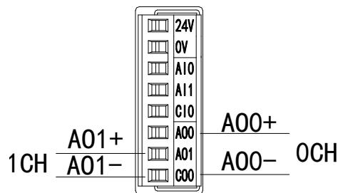
注意：电流输出无需串接 DC24V 电源！
