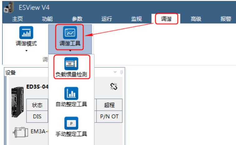
步骤 2 ESView V4 将弹出执行负载惯量检测操作的注意事项，如图 9-36 所示。
