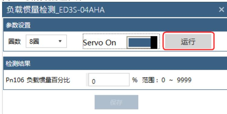
步骤 7 等待负载惯量检测操作执行完毕后，ESView V4 会将检测结果显示在对话框中，如图 9-40 所示。
