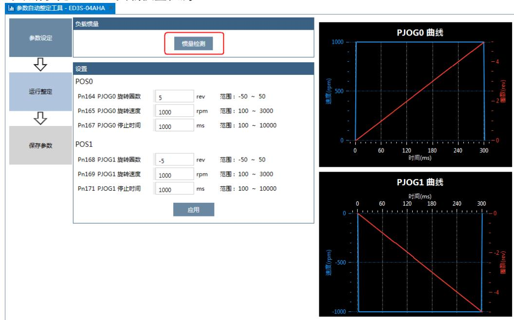
步骤5 设定 POS0 和 POS1 两个程序的相关参数。
