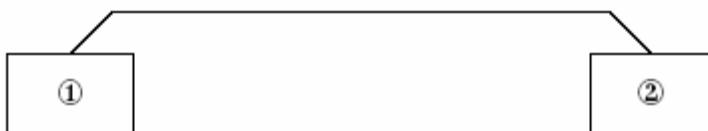
并行连接是两台同型号的 FX 系列的 PLC 通过 485 模块采用 one pair 或者 two pair 的配线连接起来, 也是通过共享存储单元的形式实现数据的交换, 但共享的范围要比 N:N 网络要多要快, 有普通模式和高速模式, 主要设置的数据寄存器有:
