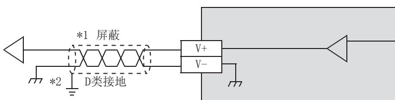
\*1 模拟输出线应使用双芯的屏蔽双绞电缆，且配线时应与其他动力线及容易受电感影响的线隔离。
