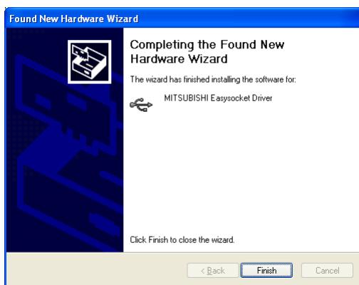
9. 显示如左所示的画面，USB 驱动程序的安装完成。
