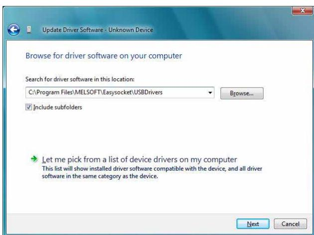
4. 显示左侧画面后，指定 USB 驱动程序的存储目标文件夹“Easysocket\USBdrivers”，点击 **Next** ( 下一步 ) 按钮。
